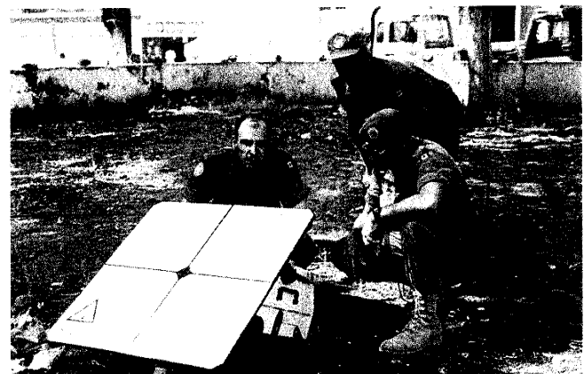
On installe un téléphone par satellite (INMARSAT), chaque fois qu'il est nécessaire d'entrer en communication avec le camp Feuille d'Erable. C'est le seul moyen qui fonctionne dans 100% des cas lorsque nous sommes en patrouille longue portée. Sur cette photo, Adjum Fournier, Bdr Girard et Bdr Lefebvre.
